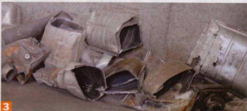
Dalle marmitte, ceramica e metallo Tre fasi della lavorazione dei vecchi catalizzatori: l'arrivo dei cestoni (foto 1), la separazione delle maglie dei catalizzatori metallici (foto 2) e il recupero delle carcasse (foto 3).
